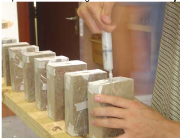
Figura 4 – Aplicação dos adesivos para posterior colagem das barras de aço.
