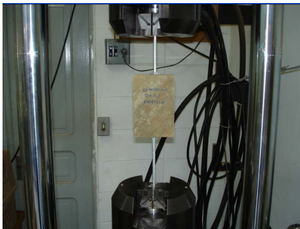
Figura 5 – Detalhe do ensaio dos corpos de prova na máquina de ensaios
